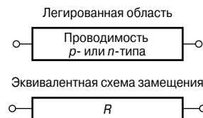
Рис. 1.3. Легированная область и её эквивалентная схема замещения.
