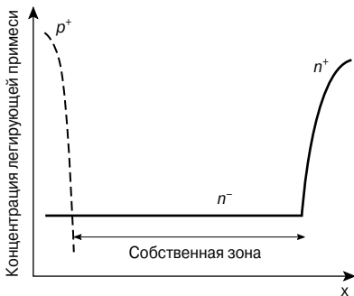
Рис. 2.1. Упрощённое представление легированного профиля p - i - n -диода.
