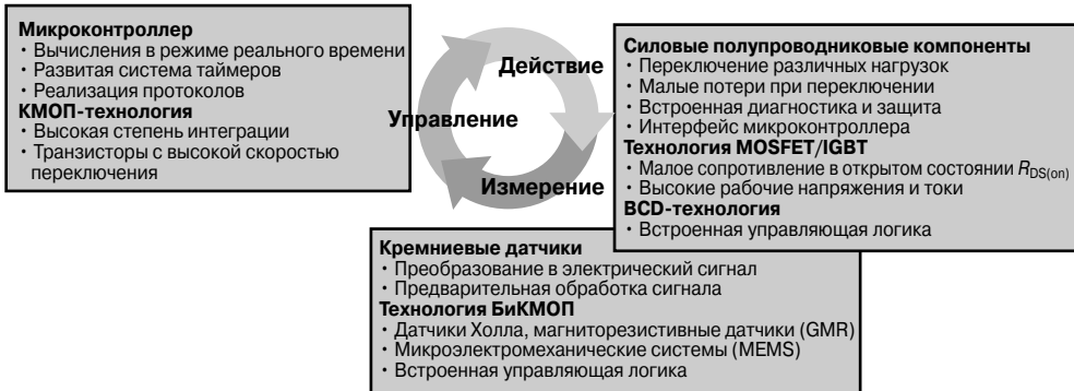
Рис. 9.29. Полупроводниковые компоненты и технологии, используемые в схемах управления трансмиссией автомобиля.
