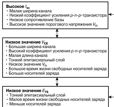
Рис. 3.164. Компромиссы при оптимизации IGBT.
