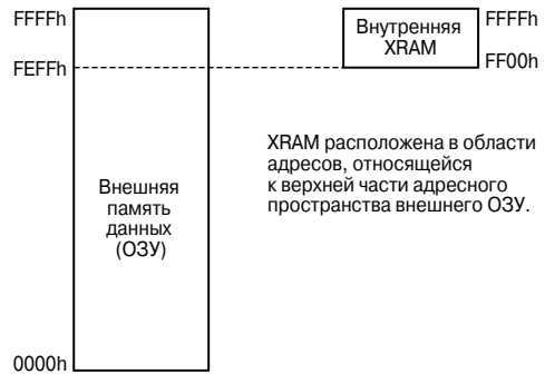
Рис. 7.3. Схема размещения XRAM в адресном пространстве микроконтроллера (в данном примере объём памяти XRAM составляет 256 байт).
