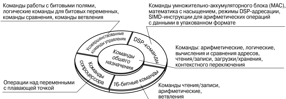
Рис. 7.35. TriCore — единая архитектура с модульным набором команд.
