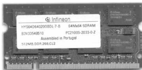
Рис. 6.18. Модули SO-DIMM, применяющиеся в переносных компьютерах. На рисунке показан модуль, объем памяти которого составляет 512 Мбайт.
