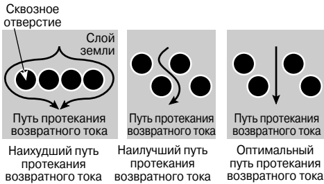
Рис. 13.49. Оптимизация путей протекания возвратных токов для ВЧ сигналов на печатной плате.
