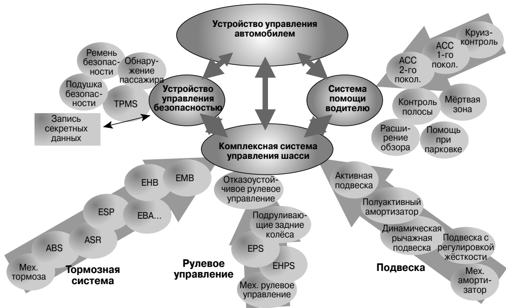
Рис. 9.19. Возможный сценарий создания комплексной системы управления шасси.
