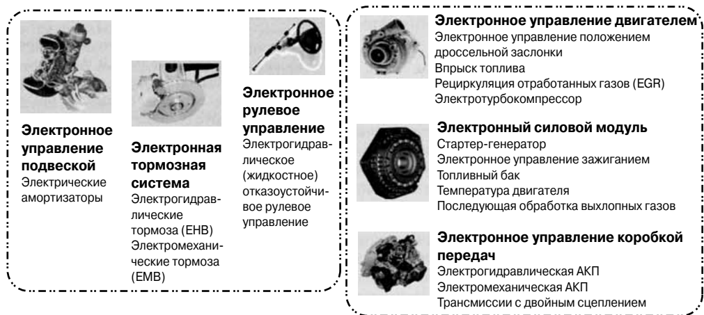
Рис. 9.55. Области применения электронных систем by-wire, предназначенных для управления трансмиссией и безопасностью/динамикой автомобиля.
