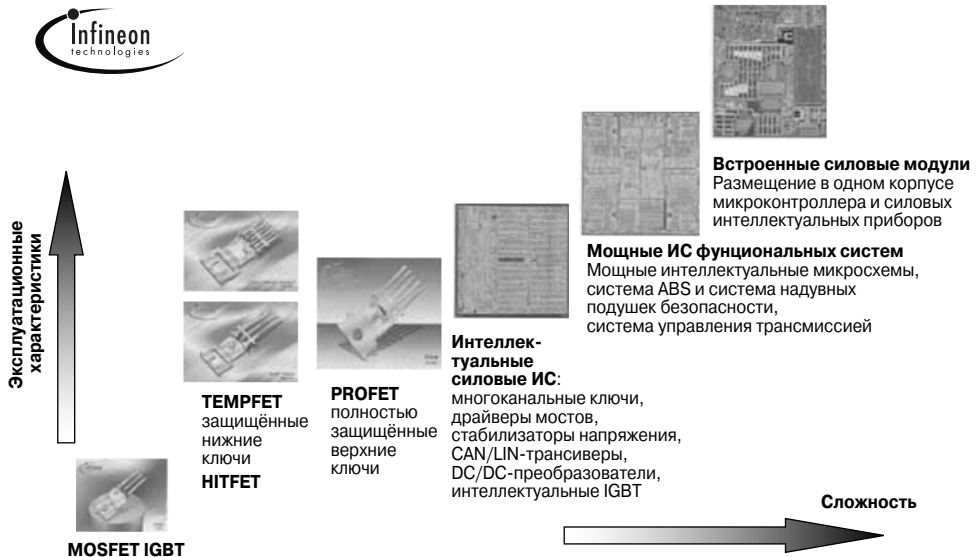
Рис. 3.6. Группы силовых полупроводниковых приборов.
