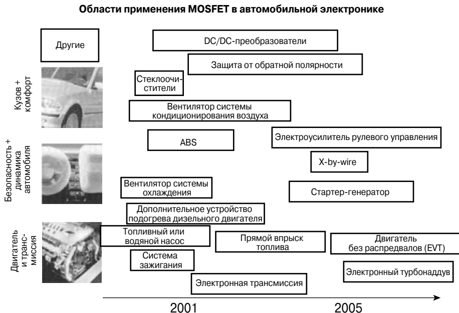
Рис. 3.56. Применение силовых МОП-транзисторов.
