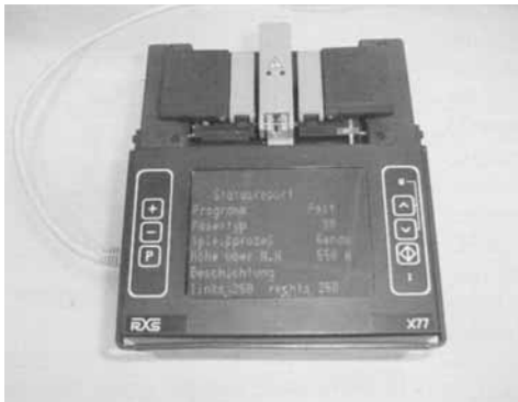
Рис. 4.27. Устройство полностью автоматизированного сращивания волокон.
