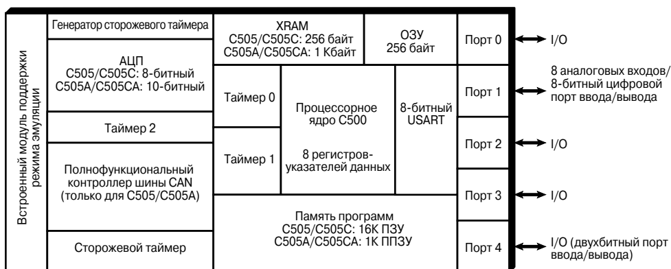
Рис. 7.16. Функциональная схема микроконтроллеров C505/C505C/C505A/C505CA.
