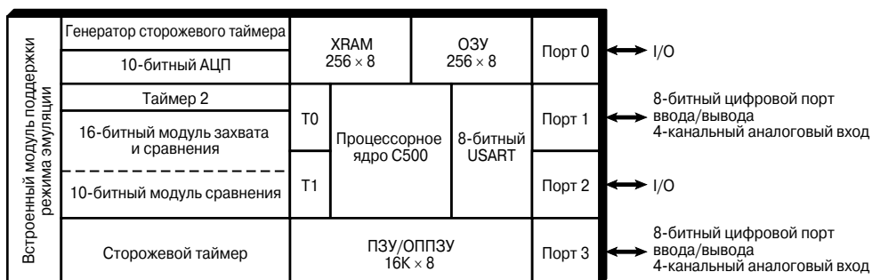
Рис. 7.15. Функциональная схема микроконтроллера C504.
