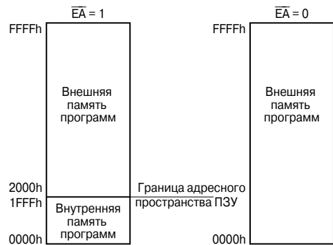
Рис. 7.1. Конфигурация ПЗУ (на примере микроконтроллера C501).
