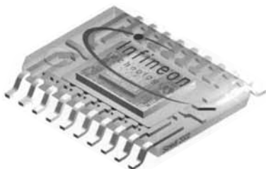
Рис. 3.54. Система в одном корпусе, изготовленная по технологии «кристалл на кристалле», корпус T-SSOP-20.
