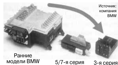
Рис. 9.1. Этапы развития контроллеров осветительного оборудования автомобиля.
