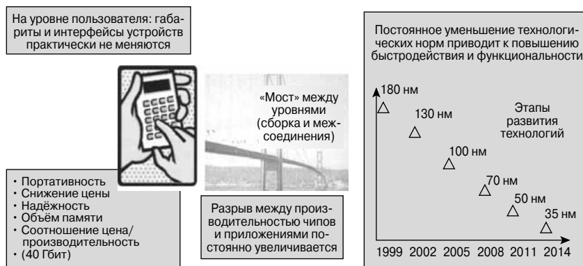
Рис. 14.2. Разработка корпуса ИС и совершенствование технологии межсоединений — «мост» между полупроводниковым чипом и прикладной схемой.
