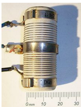
Рис. 3.5. Конструкция проволочного резистора
