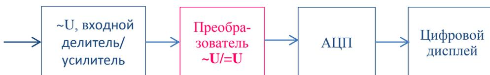
Рис. 1 Блок-схема цифрового вольтметра переменного тока
