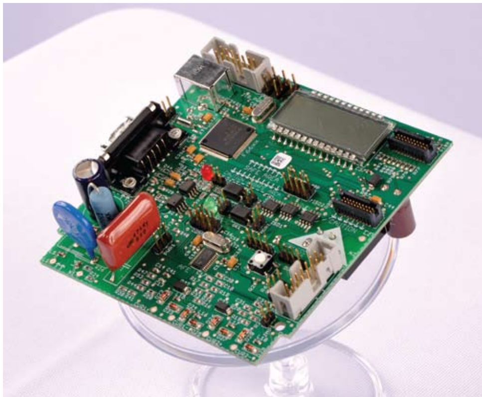
Рис. 6. Прототип однофазного электросчетчика на базе MSP430AFE253
