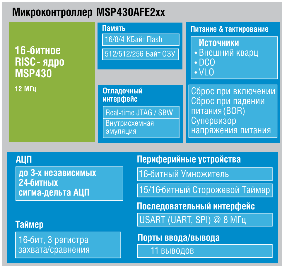
Рис. 2. Блок-схема микроконтроллеров MSP430AFE2xx
