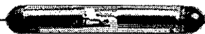
Рис. 5.42. Ртутный геркон фирмы CP Clare Corp. нечувствительный к положению в пространстве. Два блестящих участка баллона с двух сторон зоны перекрытия контакт-деталей образованы слоем амальгамы, нанесенной на внутреннюю поверхность стеклянного баллона
