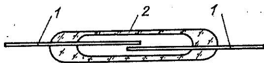
Рис. 5.3. Конструкция современного геркона:
