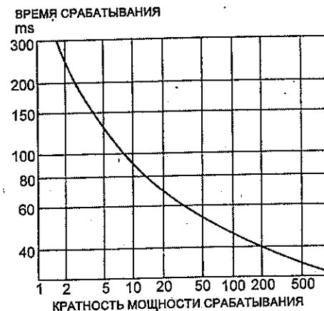
Рис. 11.9б. Время срабатывания электродинамического реле типа RP-1 в зависимости от мощности
