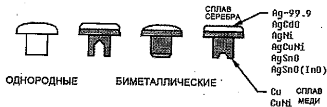
Рис. 3.2а. Контактные накладки типа заклепок
