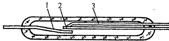
Рис. 5.9. Переключающийся геркон: 1 — неподвижная контакт-деталь замыкающегося контакта; 2 — гибкая подвижная контакт-деталь; 3 — неподвижная контакт-деталь размыкающегося контакта
