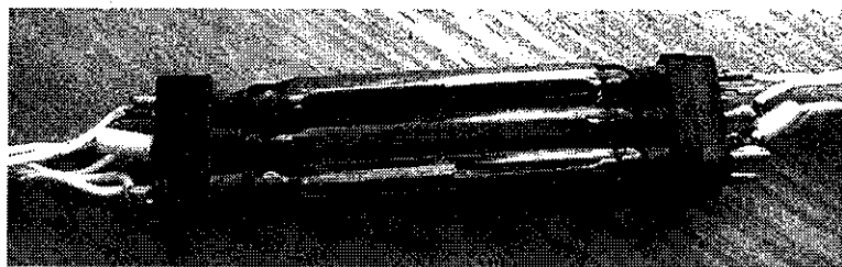
Рис. 5.68а. Блок из шести герконов нормального типоразмера (два ряда по три геркона), подготовленный для установки во внутреннюю полость катушки многоконтактного реле
